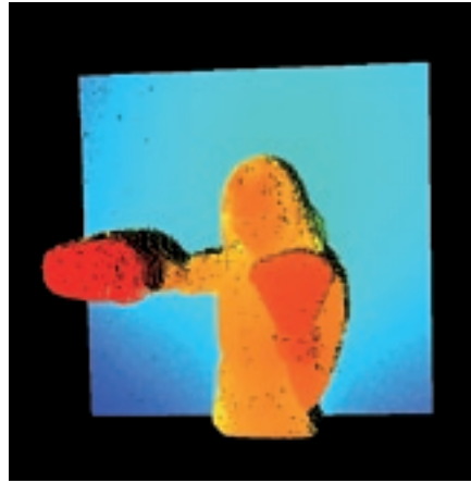
ABB. 1: Farbcodiertes Entfernungsbild (links) und Grauwertbilddarstellung (rechts) des PMD[vision] CamCube.
