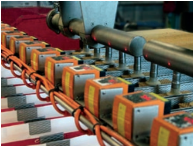
ABB. 3: Der efactor pmd in der Eisproduktion (links) und bei der Ausrichtung von Gepäckstücken (rechts, mit freundlicher Genehmigung der ifm electronic gmbh)
